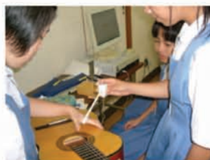
付属のマイクで音を測定し、パソコンに入力
